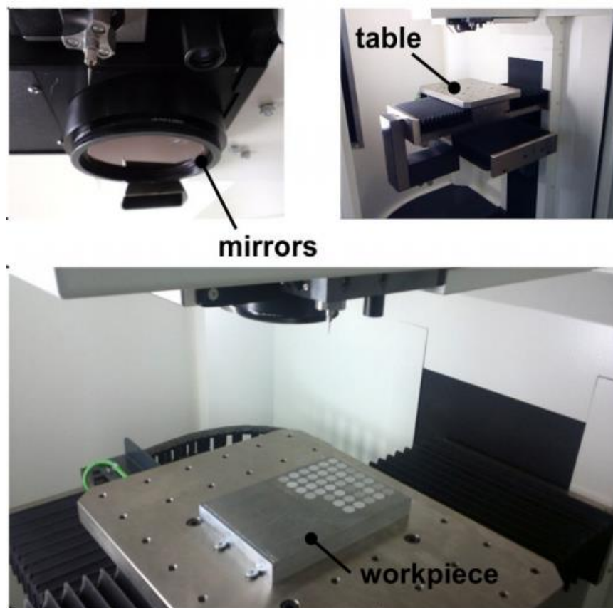
Σχήμα 4. 2: Τα βασικά μέρη του θαλάμου κατεργασίας
