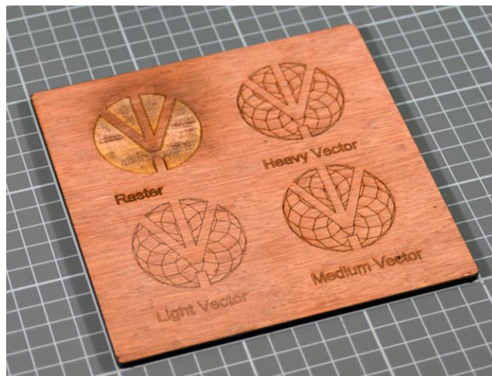
Σχήμα 2. 11: Σύγκριση των δύο μεθόδων χάραξης
